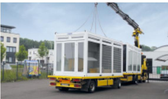
↑ TRANSPORT VON CONTAINEREINHEITEN MIT KRAN-LKW
