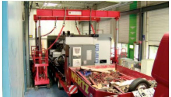
↑ ABTRANSPORT EINER MASCHINE VIA HUBBÜHNE
